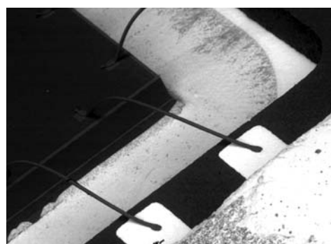
反射電子像 (低真空モード) 試料: IC ×25
