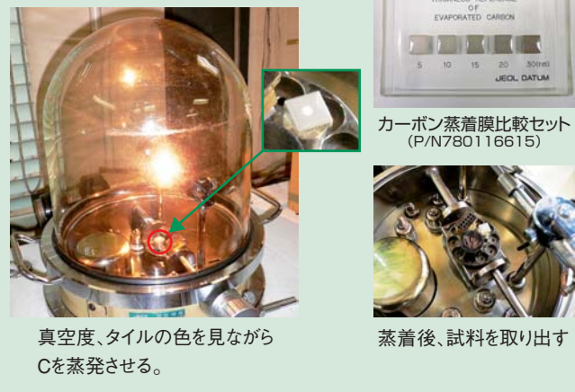
図4 C (カーボン) コーティングの一般的な膜厚制御
