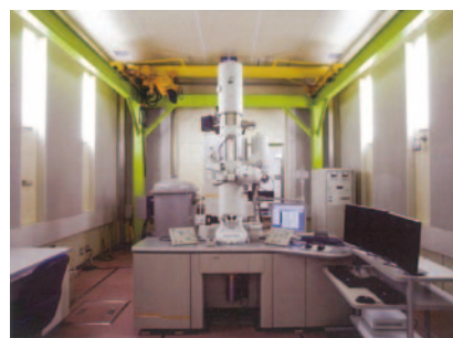
施工例:パッシブ/アクティブ磁気シールドルーム 写真ご提供:財団法人ファインセラミックスセンター(JFCC)様
