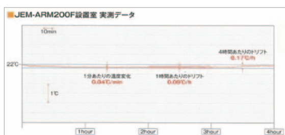
電子顕微鏡JEM-ARM200F設置室仕様の実測データ
