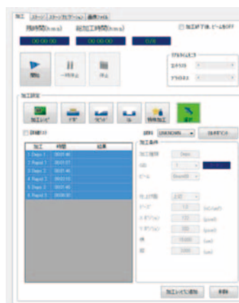
図.4 加工設定部のGUI 複雑な加工パラメータはプリセットされ、加工目的によりラピッドとミル、デポの3モードをボタンで選択できます。一度設定した加工条件は、加工レシピに登録し、再利用が可能になっています。
