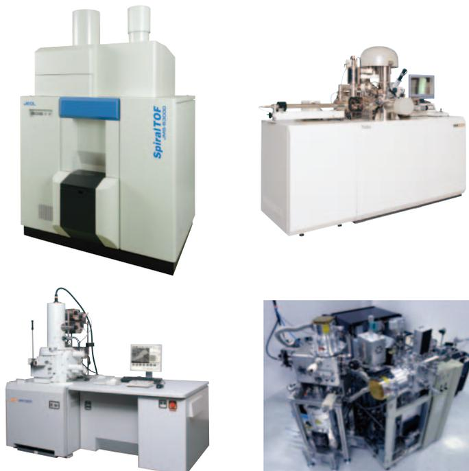
Fig. 1 使用装置外観図。左上JMS-S3000, 右上JPS-9010, 左下JSM-7001FTTLLV(EDS:OXFORD Instruments社AZtec Energy Standard X-Max50), 右下TOF-SIMS(京都大学所有)
