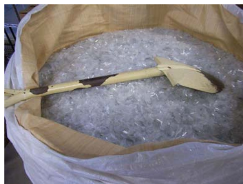
廃蛍光管破碎ガラス
