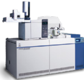
① ダイオキシン類分析専用質量分析計 JMS-800D
