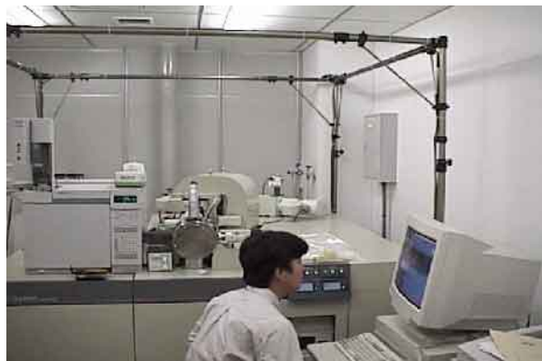
図4-1 高分解能質量分析計にアクティブ磁場キャンセル装置を設置した例
