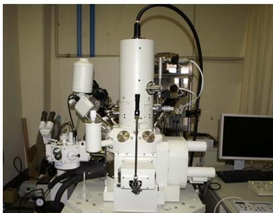
Fig. 1 JIB-4601F に取り付けられた ALTO2500 の概観
