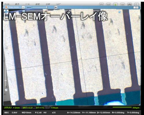
光学顕微鏡像連動ソフトウェア\*を用いて、変色部とSEM像を一致させ、拡大して観察します
