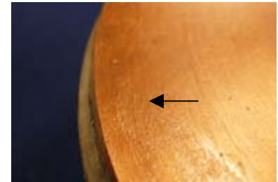
図1. 金属表面の有機不純物 (セラミックペーパーでふき取り測定)
