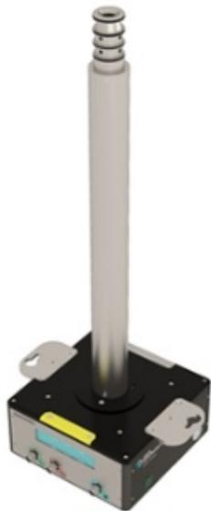
新世代拡散プローブは、自己拡散測定に特化した、大きな磁場勾配が印加可能なプローブです。コイル周りのデザインを改良することにより、磁場勾配パルス後のリカバリー時間が従来機に比べ大幅に短縮されました。拡散係数の小さな高分子溶液や、磁気回転比の小さい核種、また近年開発が活発な固体電解質中のイオンのダイナミクス解析に最適です。
