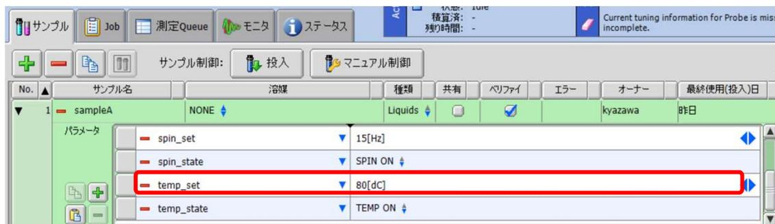
設定温度は上図の様にSampleパラメータ中の"temp\_set"で設定します。
