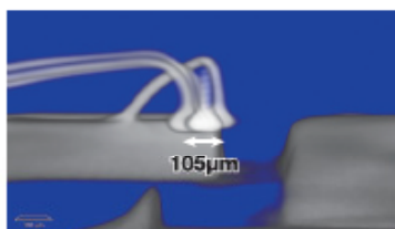
μCTで非破壊断面構造確認・簡易測長
