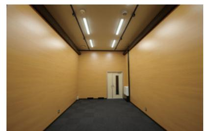
電子顕微鏡室 木質吸音板施工例
