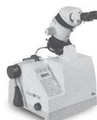
断面試料作製装置
