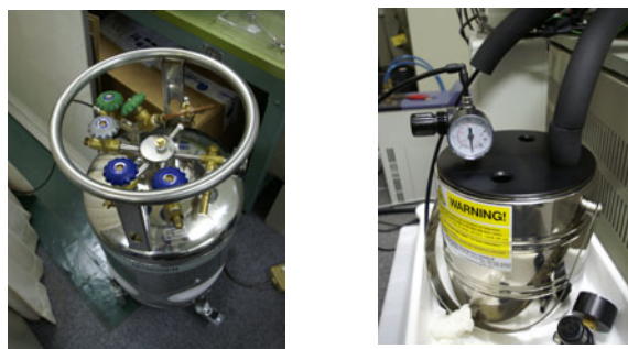
図 4 窒素ガス供給タンク(左)と窒素ガス冷却槽(右)
