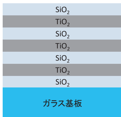
積層膜の模式図 (IRフィルター)
