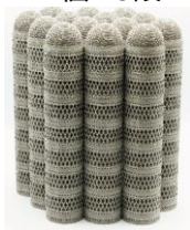
材料：Ti64 造形物：ヒップカップ（人工股関節）
