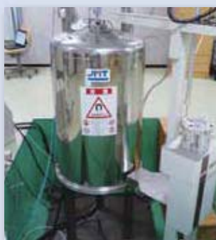
【床を掘ったスペースに設置された600MHz zマグネット】
