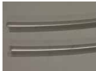
図1. 光ファイバー (ポリメタクリル樹脂)
