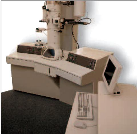
図1 透過電子顕微鏡の新しい操作システム(FasTEM)の外観
