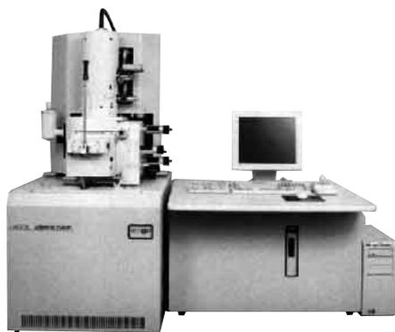
冷陰極電界放射形電子銃(コールドFEG)
