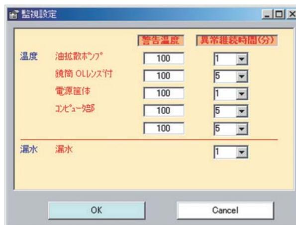
監視条件設定画面で温度センサの設定温度および異常持続時間の設定、漏水時の異常持続時間の設定を行います。
