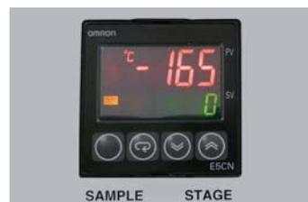
温度はデジタル表示、温度制御機能を利用して、試料温度設定は任意に行えます。
