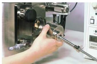
蒸着材料、試料、ナイフ交換はすべてロードロック方式
