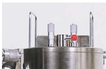
蒸着材料は二極切換え送り出し機構
