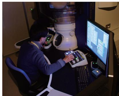
JEM-ARM200F の導入に併せ、設置環境対策として弊社の輻射パネル方式精密温度コントロールシステム、アクティブ除振装置、アクティブ磁場キャンセラーも導入いただいておりますが、それらの効果につきましてはいかがでしょうか。
