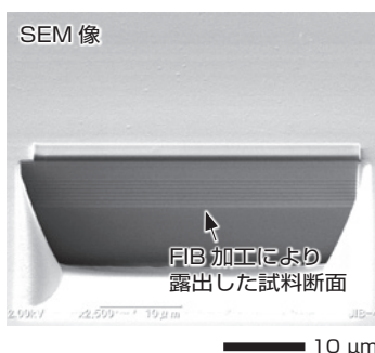
加工直後の FIB 観察像 (SIM 像) と SEM による斜め観察例
