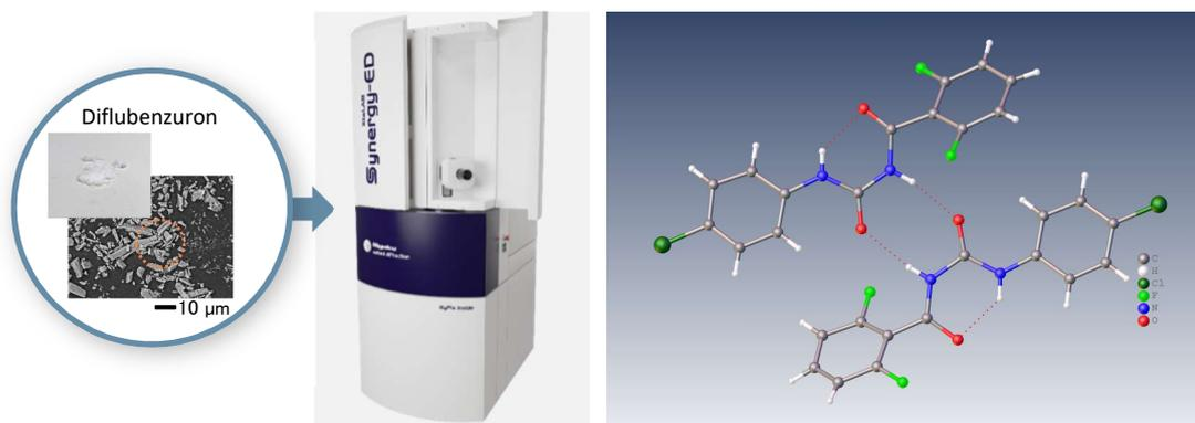
左：JCM-7000 NeoScope™によるDiflubenzuronの低真空モード反射電子像
