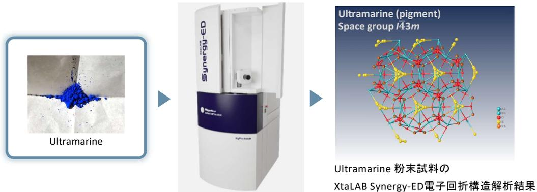
XtaLAB Synergy-EDは、微小結晶の電子回折図形の取得に最適化された電子回折装置です。無機および鉱物などの粉末試料を、そのままの状態でも分子構造解析を行うことが可能です。さらに日本電子のエネルギー分散形X線分析装置 (Energy Dispersive X-ray Spectrometer, EDS)による詳細な元素分析と組み合わせることで、サブミクロン結晶のより最適な分子構造解析が可能です。
