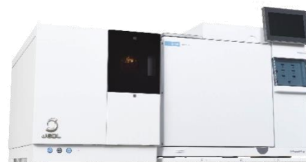
ガスクロマトグラフ三連四重極質量分析計 (GC-MS/MS) JMS-TQ4000GC
