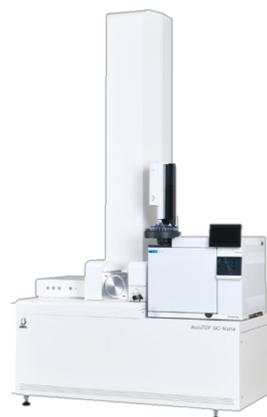
ガスクロマトグラフ飛行時間質量分析計
