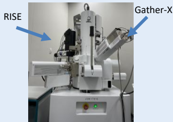
装置構成 SEM: JSM-IT810SIL (JEOL) EDS: Gather-X (JEOL) Raman: RISE (Oxford)
