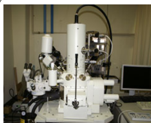
付図1 JIB-4600Fに取り付けたALTO2500
