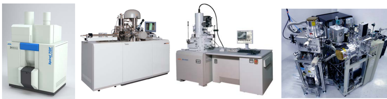
Fig. 1 使用装置外観図。左から JMS-S3000, JPS-9010, JSM-7001FTLLV (EDS: OXFORD Instruments 社 AZtec Energy Standard X-Max50), TOF-SIMS ( 京都大学所有 )
