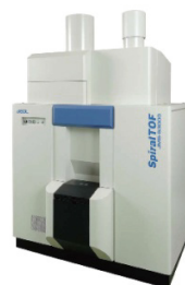
分析機器の最先端をリード、世界最長の飛行距離 JMS-S3000 SpiralTOF™
