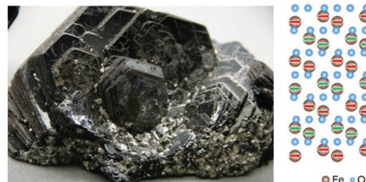
図3 ヘマタイト ( \alpha\text{-Fe}_2\text{O}_3 ) 結晶の外観と室温における原子構造およびFe原子の磁気モーメント配列 (矢印) の模式図
