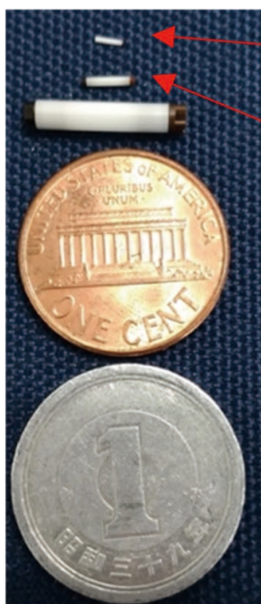
今回開発したプローブ (左) と直径0.4 mmのMASローター (試料管) (右)
