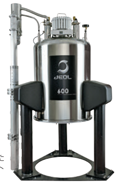
冷媒蒸発抑制装置を装着した NMR用超伝導マグネット
