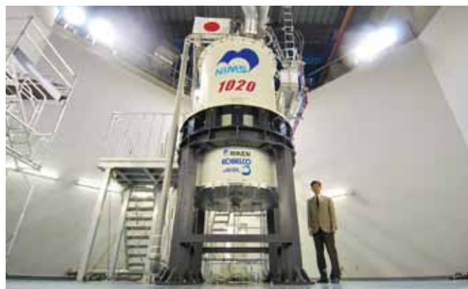
今回開発した 1020 MHz 超伝導磁石 高さ約 5 m、重さ約 15 トン
