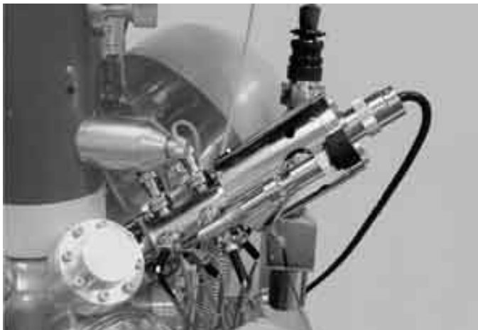
図1 フローティング形イオン銃(FMIED)の外観
