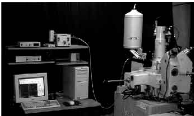
図1 EPMAおよびCL装置概観
