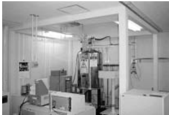
図1 NMRへ組み込んだアクティブ磁場キャンセラー 白い柱の中にヘルムホルツコイルが配線されています。
