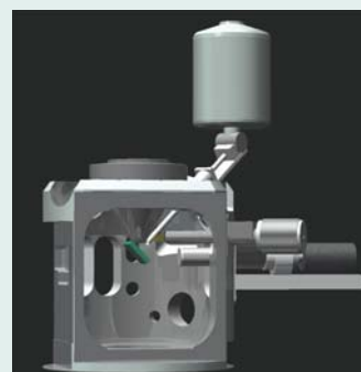
二次電子検出器、EDS、EBSDの 同時使用例
