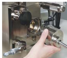
蒸着材料、試料、ナイフ交換は全てロードロック方式
