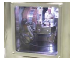
LED照明、大きな観察窓、双眼ルーペにより、切削、蒸着、試料交換などの作業を観察しながら容易に行なえます。
