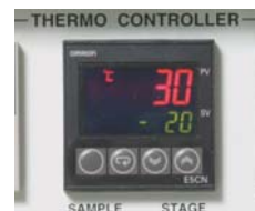
温度はデジタル表示、温度制御機能を利用して試料温度設定は任意に行なえます。
