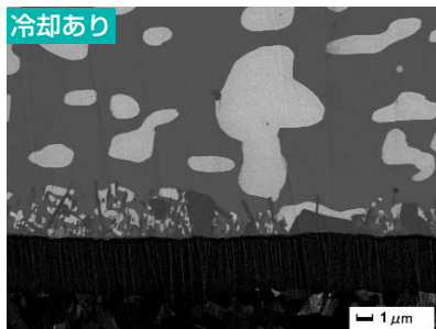
試料冷却によりPb-Sn界面の空隙を抑えることができます
