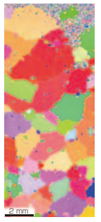
広い領域でのEBSD解析(試料:鉄 加速電圧20 kV、×10、測定範囲:6.7 mm × 15 mm)
