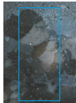
広い領域でのEBSD解析(試料:鉄 加速電圧20 kV、×10、測定範囲:6.7 mm × 15 mm)
