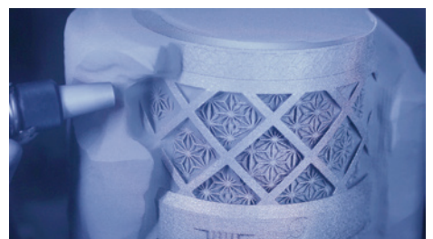
6. 最終層まで造形後、仮焼結された粉末をプラストで除去し完成
