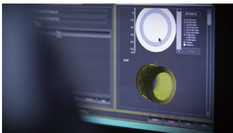
1. 造形物の 3D CAD データを入力する
