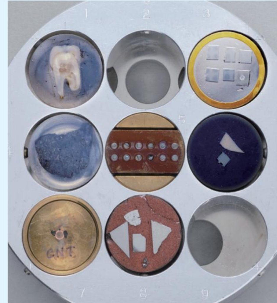
試料交換室の排気中にステージナビゲーション画像撮影
